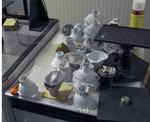
Le parabole dei fari da scansionare vengono opacizzate per evitare riflessi di luce indesiderati; i marker servono al software di elaborazione per ricostruire con precisione la geometria in presenza di riprese multiple
